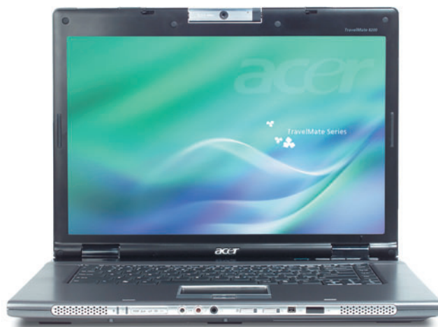
Корпус TravelMate 8200 усилен углеродным волокном
